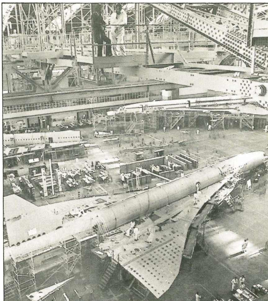
Sala de montagem da British Aircraft Corp., em Filton, Inglaterra, vendo-se os Concorde em vários estágios de construção. Foto BNS
