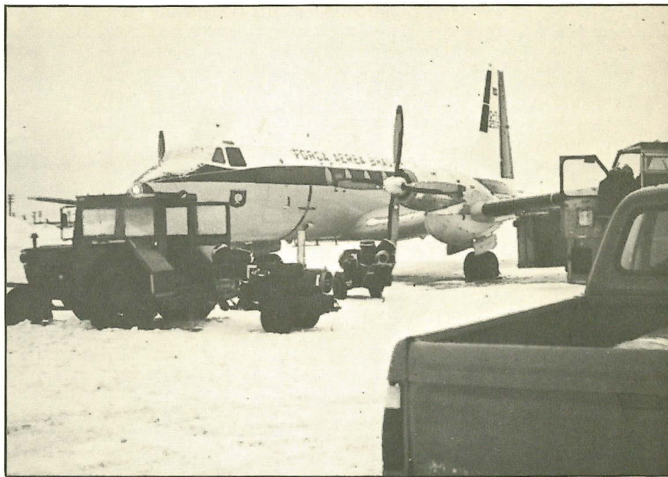
Keflavik Air Force Base — EE.UU. — Islândia. Equipamento de solo: Fonte de Força; Fonte de aquecimento com mangueiras; à direita, lançador de álcool para banho no avião.
