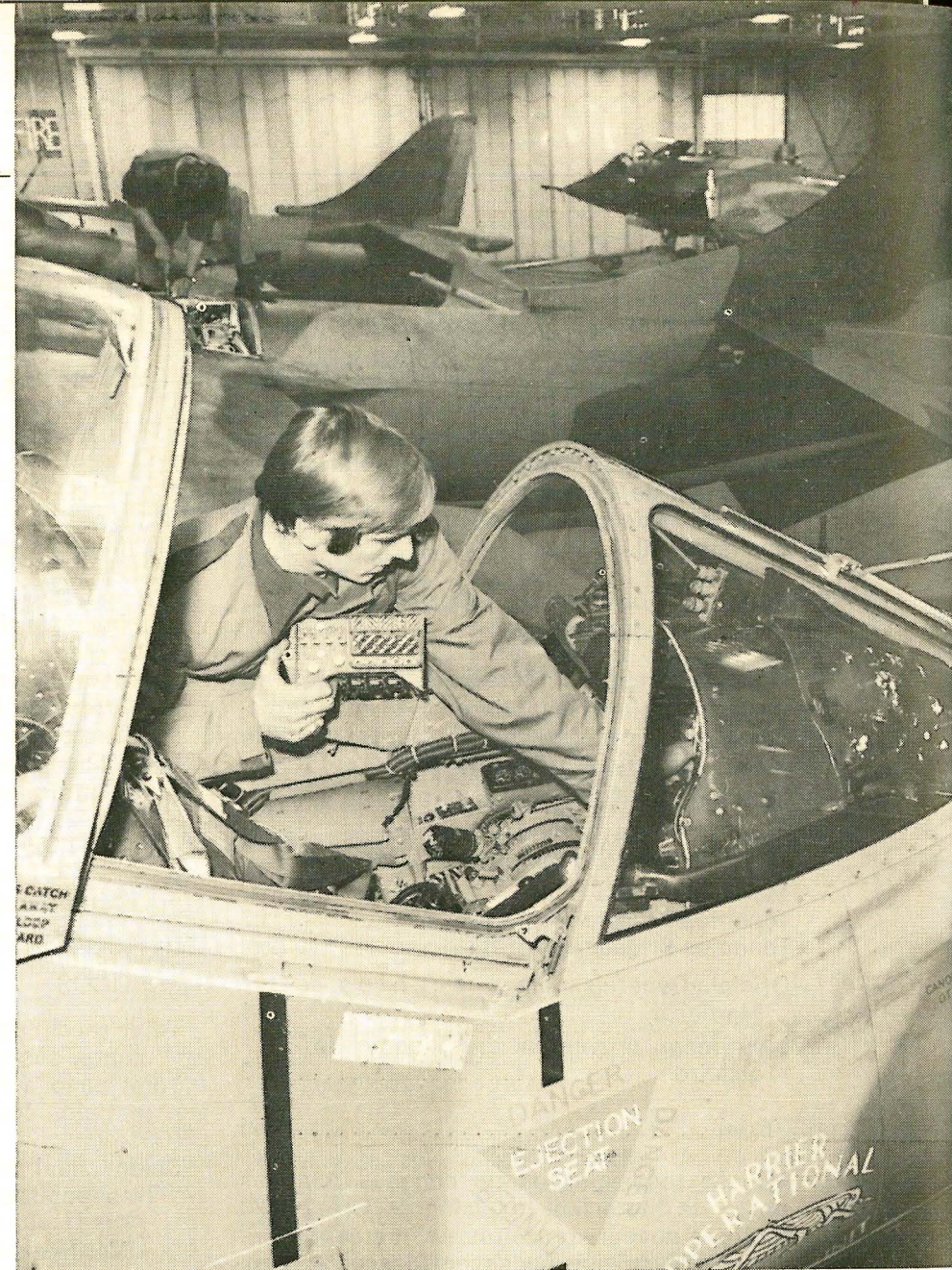
Um técnico da RAF instala o WCS num caça Harrier. Foto BNS
