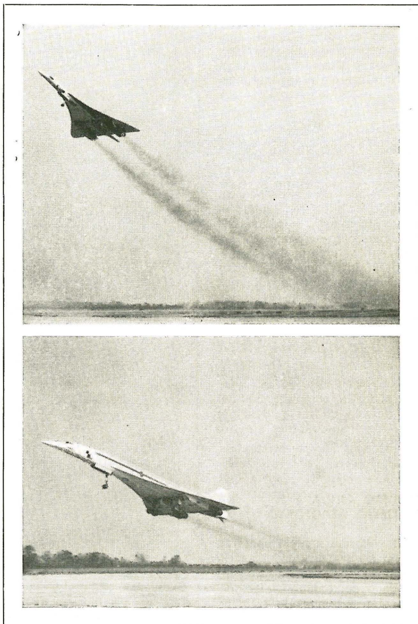
O Concorde 02 (no alto) e o 01 (em baixo) mostraram, em dias sucessivos, a redução da fumaça do escape
