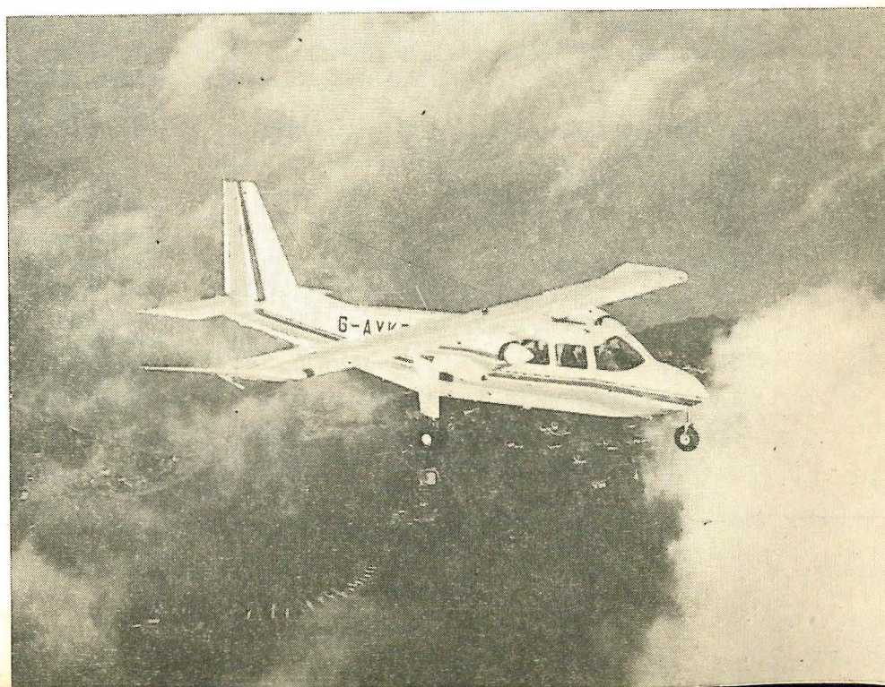
O Britten-Norman BN 2A3 Islander, equipado com motores Lycoming IO-540 K de 300 HP.
