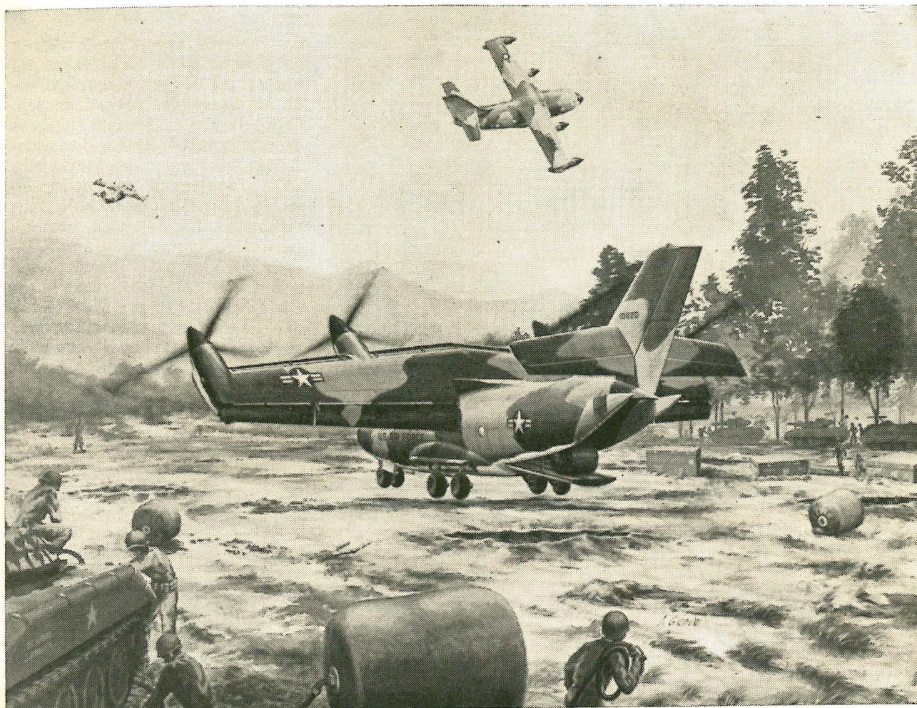
O LIT, visto na concepção artística, poderá passar, em vôo rasante, a menos de 60 km/h, enquanto os aviões atuais não permitem menos de 150. Isso garante-lhe precisão no lançamento da carga e diminui as possibilidades de avarias do material despejado.
