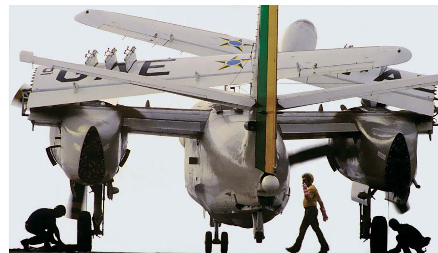
As asas dos P-16 podiam ser dobradas, facilitando as operações no espaço limitado convés
