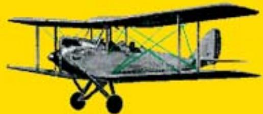
Aviões biplanos, monomotores para dois tripulantes, foram fabricados pela firma inglesa *De Havilland Aircraft Co. Ltd.* Segundo documento do Ministério da Marinha de 1932, os DH 60T deveriam ser armados e operados pela DAL (Defesa Aérea do Litoral), receberiam porta-bombas e metralhadoras e os visores seriam alças ALDIS. Dos 24 comprados em 1932, um deles foi transferido para o Ministério da Aeronáutica, em 1941.
