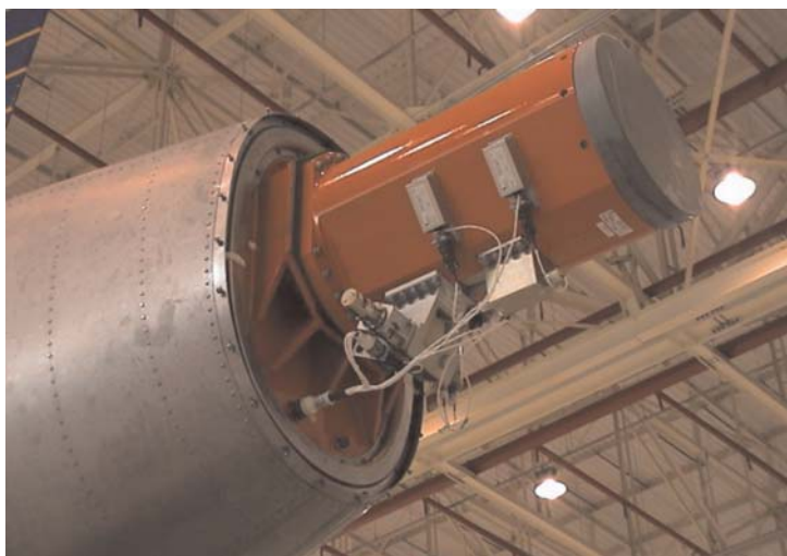
Equipamento especial: pára-caudas e o comando de disparo
