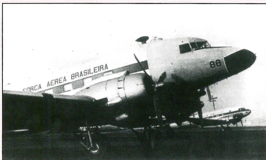
Um dos EC-47 utilizados pelo GEIV – Grupo Especial de Inspeção em Voo – para calibragem de auxílios-rádio. A unidade aérea operava do Aeroporto Santos-Dumont. Na foto, bem destacado, o nariz alongado, alojamento dos equipamentos eletrônicos para testes.
