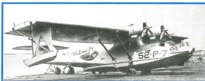
PBY-5 da U.S. Navy, em 1941. Podem ser perfeitamente identificados os conjuntos de rodas destacáveis, usados para movimentação e manobra do aerobote quando fora da água. Outras características notáveis são as bolhas transparentes nas laterais e os flutuadores retráteis, na posição de pouso n' água.
