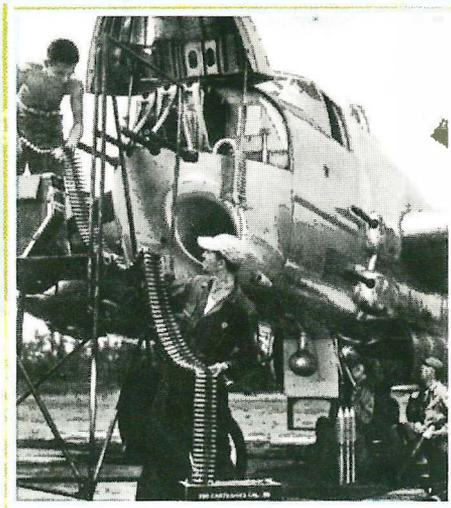
Um *B-25H* sendo remuniciado antes de uma missão de ataque na área do Pacífico. Na foto podem ser vistas as quatro metralhadoras .50 mm existente no nariz; as duas na lateral da fuselagem e o tubo por onde eram feitos os disparos com os canhões de .75 mm (lateral inferior esquerda do nariz).
