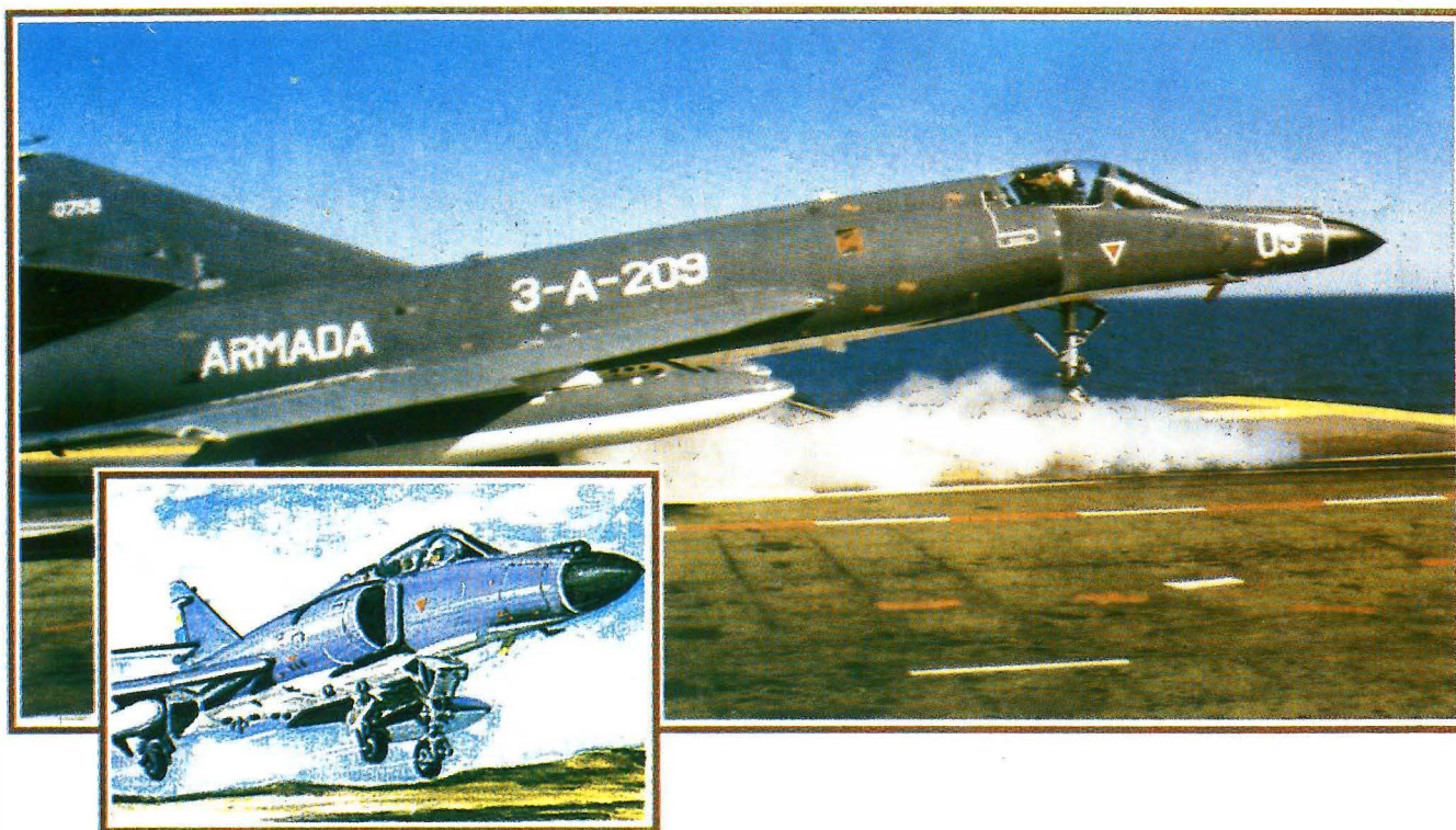
Os "Super Etendard 3-A-206 da 2ª Esquadilha Aeronaval operaram de Rio Grande devido ao afastamento por motivos técnicos do porta-aviões ARA 25 de Mayo, da área do combate. Na ilustração menor, podemos ver o "Super Etendard" decolando para a missão contra o "Invencible", levando um míssil "exocet" sob a asa direita e um tanque subalar, na esquerda.
