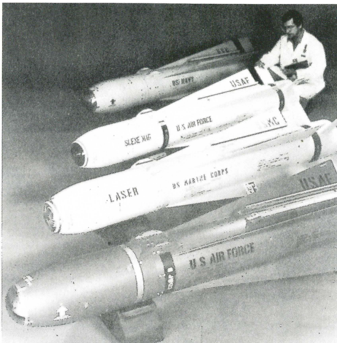
Família de mísseis Maverick utilizados nos A-10 "Thunderbolt", com guia IR, lasérica e por TV.
