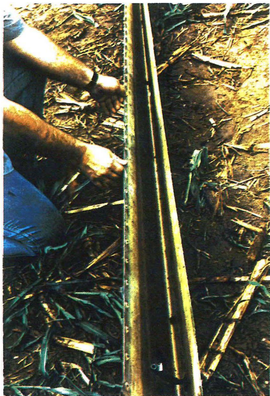
Bordo de ataque do estabilizador horizontal — encontrado distante dos destroços, sem os parafusos de fixação
