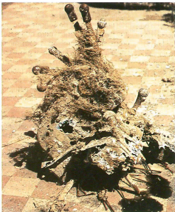
Pedestal de manetes, normalmente buscando pelos técnicos em investigação.
