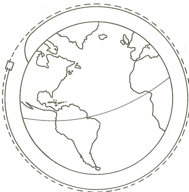
Figura 2 – Intercepção co-orbital Método utilizado pela Rússia em seu sistema anti-satélite. A interceptação é feita na primeira ou no máximo na segunda órbita. O satélite é destruído pelo impacto de estilhaços disparados em sua direção pelo anti-satélite.
