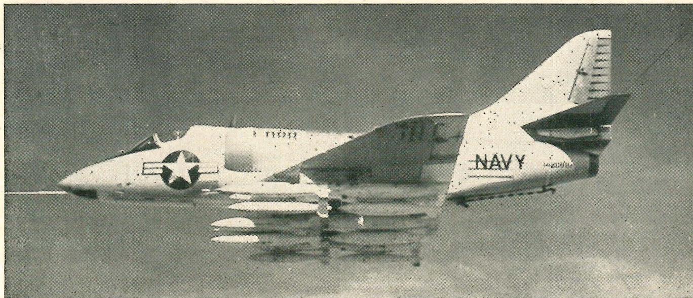
ARSENAL VOLANTE — O novo adaptador do porta-bombas do avião de ataque "Skyhawk A4D" aumenta a capacidade de bombas para seis vezes a carga normal
