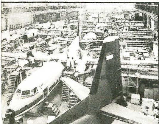
Linha final de montagem do F-27
