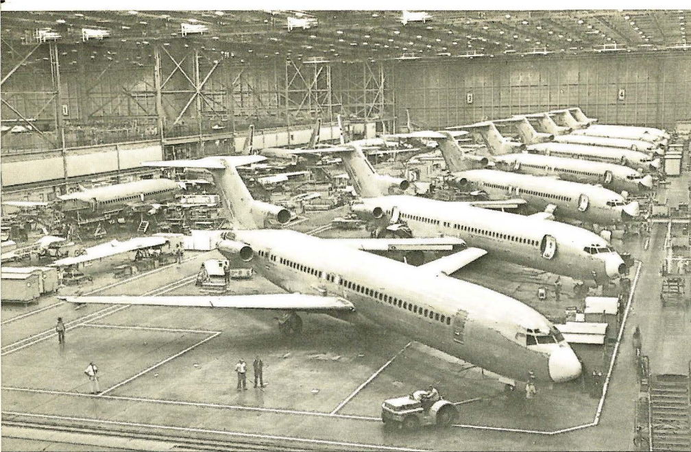
Linha de montagem final dos Boeing 727 e 737
