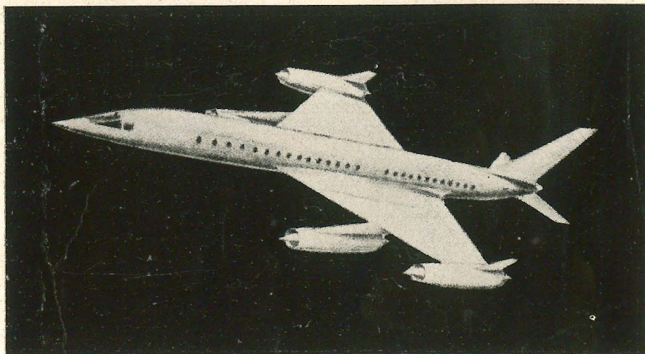
Versão de transporte do B-58 proposta para operações militares e transporte civil. O avião cruzará a Mach 2,4 e transportará 52 passageiros.
