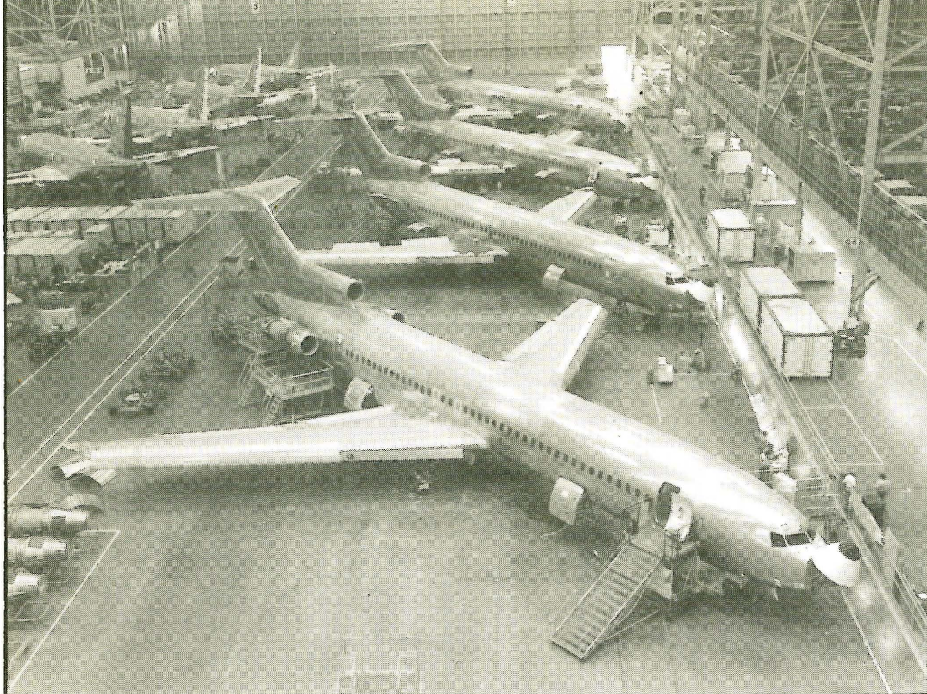
Linha de produção do Advanced 727-200 na Boeing. A média de produção desse popular trijato é de cinco por mês. Ao fundo, a linha de montagem do birreator 737.
