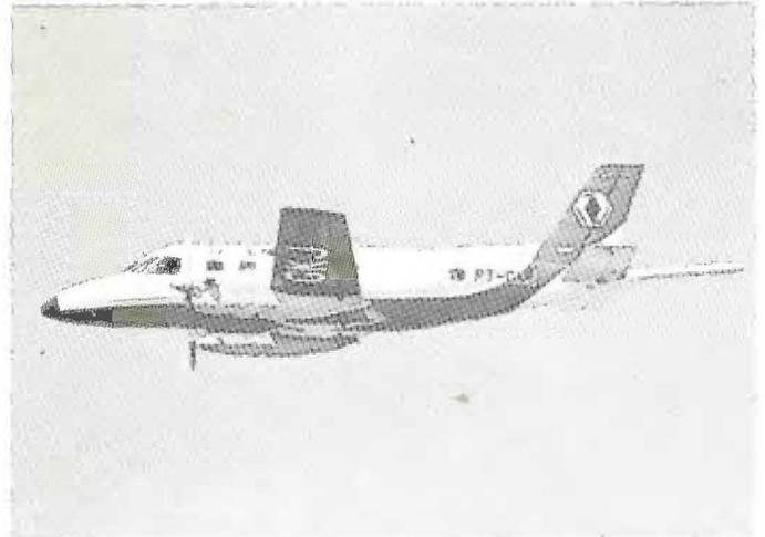
*Bandeirante PT-GKJ em que foi feita a travessia do Atlântico e da África. Notar na cauda os sensores dos equipamentos de prospecção*
