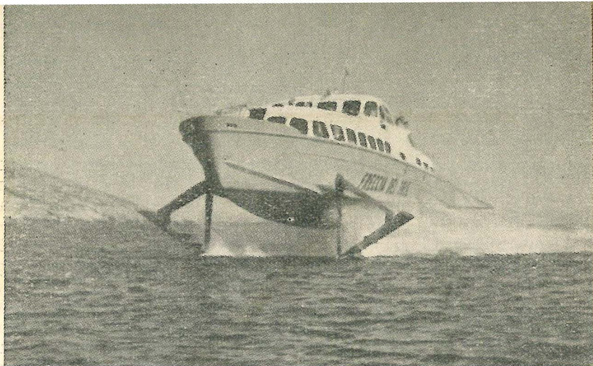
O hidrofólio "Flecha do Sol", construído pela "Aliscafi", construtora naval italiana. É dotado de grande estabilidade, desenvolve alta velocidade e tem capacidade para 72 passageiros. É utilizado para navegação entre a Sicília e a Grécia
