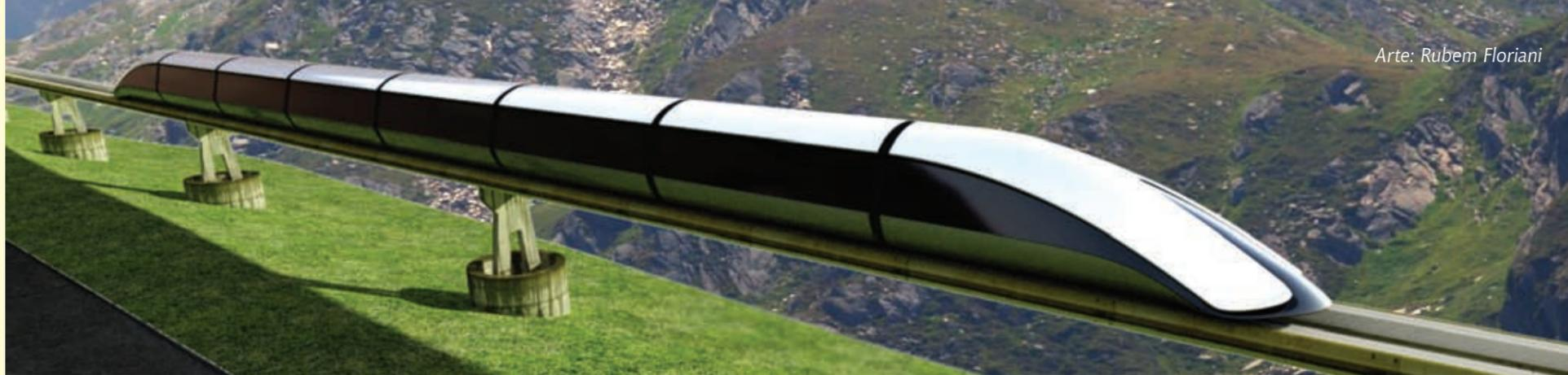
Eletrodinâmica (ELD) – levitação baseada na Lei de Lenz, enunciada por Heinrich Lenz (1804-1865), sobre a geração de força repulsiva em campo magnético criado por bobinas supercondutoras em movimento relativo a um condutor. Tecnologia desenvolvida no Japão, onde o TAV EDL atingiu mais de 580 km/h;
