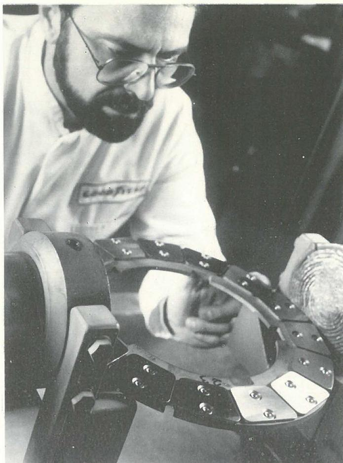
Novas pastilhas aplicadas num disco de freio para trem de pouso passam por rigoroso exame de um técnico da Air Treads nas instalações da empresa em Moerfelden, Alemanha Ocidental.
